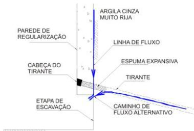
Figura 16. Fluxo de água atrás da vedação da cabeça do tirante.
